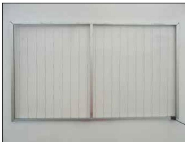
**Figura 4.** Electrodo de descarga.
