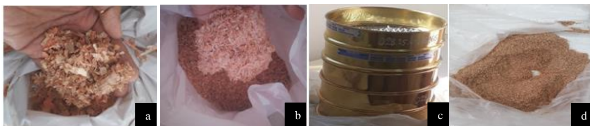
Figura 3. Proceso de obtención de partículas de madera. a y b) Aserrín antes y después de pasar por la trituradora, c) tamices utilizado para el aserrín y d) Aserrín después del tamizado 600 \mu\text{m} .
