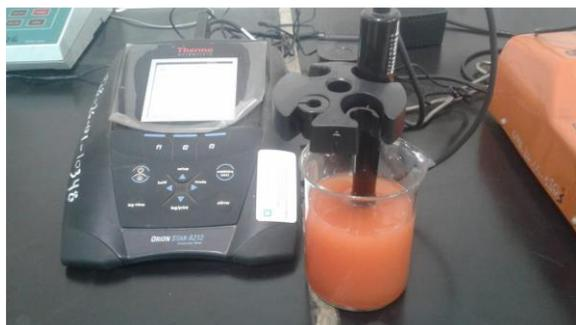
**Figura 2. Lavado del Adsorbente con agua destilada y Etanol p.a. para estabilizar conductividad. Cuantificación de la conductividad con (Thermo Fischer Orion Star A111).**
