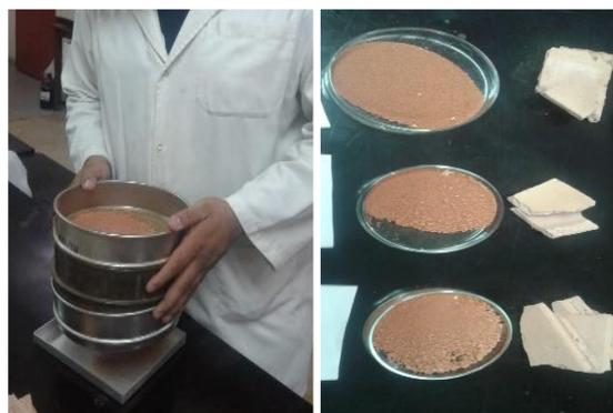
**Figura 1.** Proceso de tamización de los bloques cerámicos utilizados como adsorbente cerámico. Izquierda, tamizado manual con tamiz 0,250 mm. Imagen a la derecha, producto final de tamizado.
