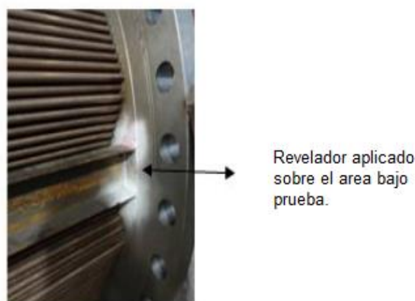
Figura 3. Pieza bajo examen con el revelador aplicado a un área específica. Fuente: Aglawe y Soni (2015).
