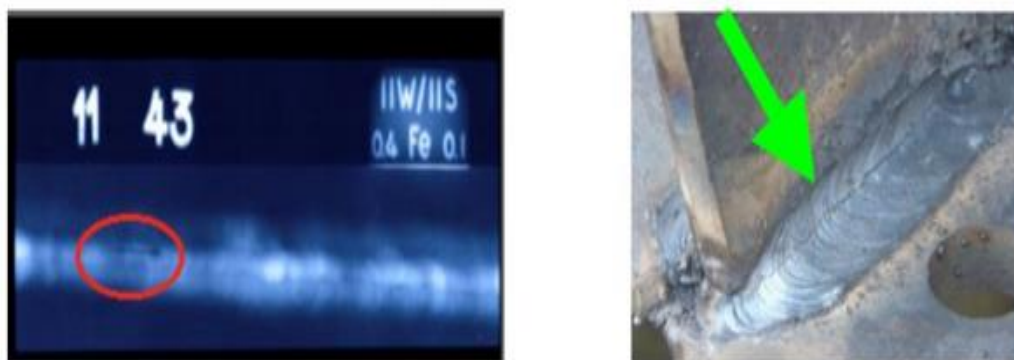
Figura 2. Fisura longitudinal en imagen radiográfica y foto de la pieza. Fuente: Madani y Azizi (2015).
