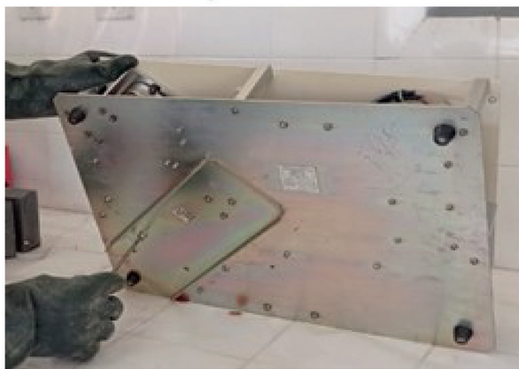
Figura 3. a) Equipo irradiador de dosímetros sin carcasa. b) tornillos ubicados en la parte inferior del equipo.
