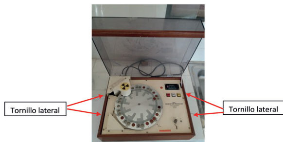
Figura 1. Equipo irradiador de dosímetros con \text{Sr-90/Y-90} Vinten Instruments.
