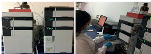
Figura 5. Lectura de las muestras y equipo de HPLC utilizados en la cuantificación de contaminantes emergentes. Laboratorio del Departamento de Investigación y desarrollo OIAT-INTN.
