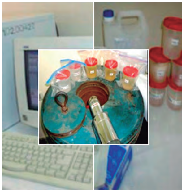
Figura 1. Sistema de Espectrometría Gamma, Mediciones In Vitro (Laboratorio CNEA- UNA).
