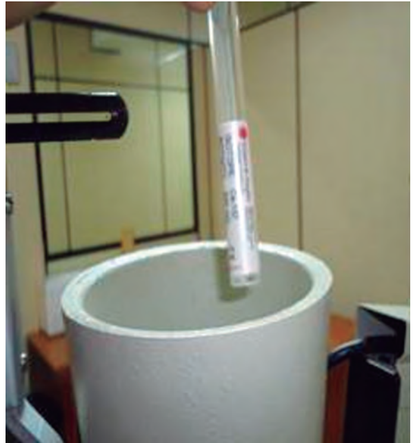
Figura 3. Fuente de Cesio 137 en el detector.
