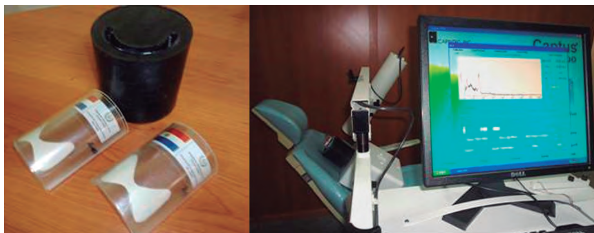
Figura 5. Calibración con Fuente de Ba 133 .
