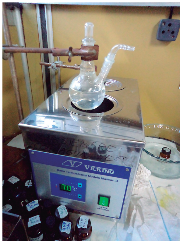
Figura 1. Reactor y baño termostático utilizado para ensayos con nitrofenoles.
