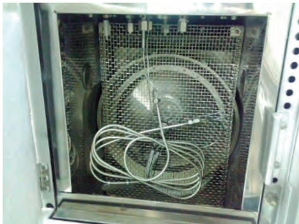
**Figura 3.** Columna Empaquetada "Porapak Q"
