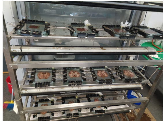
Figura 15. Aplicación de luz UVA con temporizador cada 15 minutos para la polimerización final.
