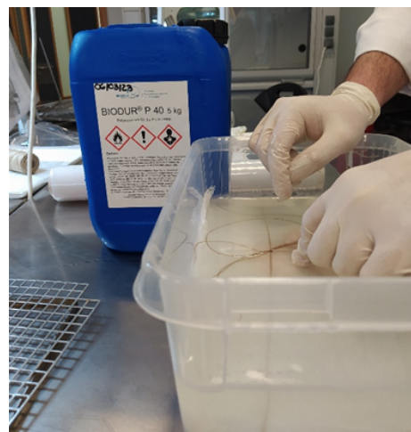
Figura 10. Preparación de las piezas para polimerización
