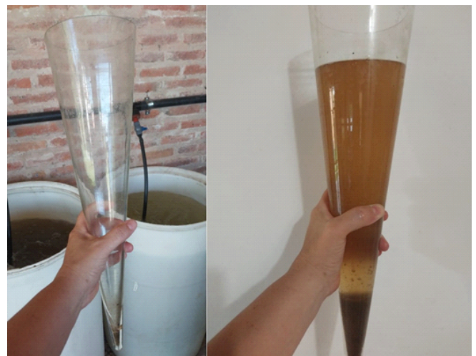
Figura 1. Vista del cono Imhoff utilizado para la evaluación periódica de los sólidos en suspensión en el sistema.
