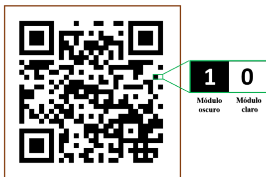
Figura 4. Ejemplo de un módulo oscuro y otro claro.
